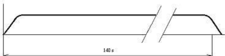
Ukázka modulace nepřerušovaného tónu signálu „Zkouška sirén“.
